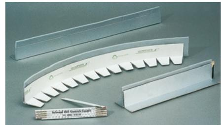
Das **FRIWA-Dehnfugenprofil L** besteht aus einem **FRIWA-Abstellwinkel** an den ein **FRIWA-LIN**-Streifen in der Dicke von 5 mm oder 10 mm ankaschiert ist. Der **FRIWA-LIN**-Streifen reicht ca. 10 mm über den Abstellwinkel.
